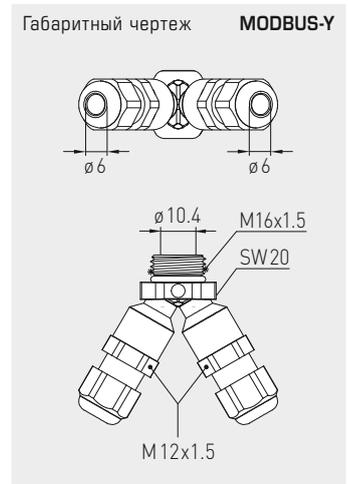
Габаритный чертеж MODBUS-Y
