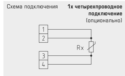
Схемы электрического подключения для монтажных силуминовых головок Б-образной формы
