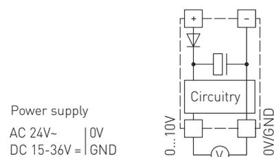
**Схема подключения** **Параллельное подключение**
