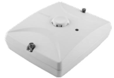
Беспроводная точка доступа для синхронизации
