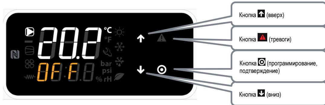
**↑** и **↓** - Используются для перемещения между пунктами меню и страницами с параметрами. Если параметр находится в режиме редактирования (поле с параметром мигает), то с помощью данных кнопок производятся изменения параметров.
