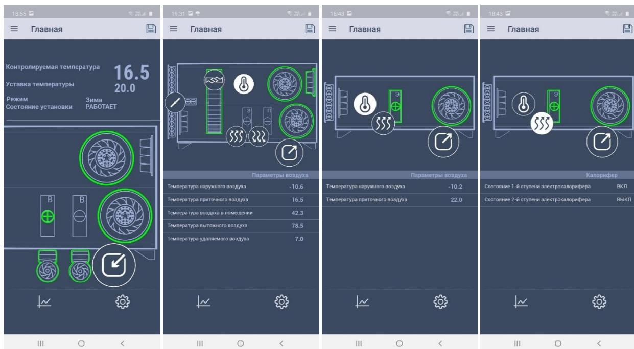
При подключении по интерфейсу NFC экран состояния установки не отображается, т.к. этот интерфейс требует поднесения смартфона к контроллеру для каждого обновления информации, соответственно, динамическое отображение значений состояния установки невозможно.
