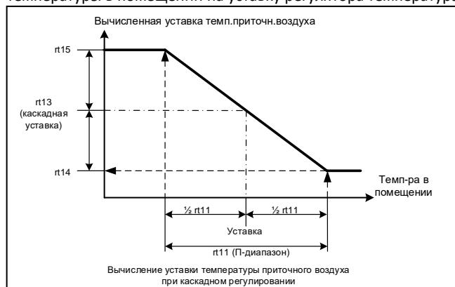
Воздействие на уставку температуры приточного воздуха показано на рисунке: при снижении комнатной температуры уставка температуры приточного воздуха повышается, при повышении комнатной температуры уставка температуры приточного воздуха понижается. Изменение происходит относительно каскадной уставки в зоне, ограниченной абсолютными значениями, задаваемыми с помощью параметров rt14 и rt15.
