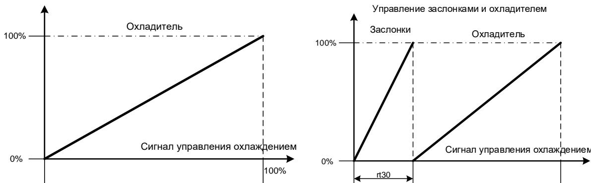
Сигнал управления охладителем блокируется при снижении наружной температуры до значения параметра rt04 (если используется датчик наружной температуры) и, если при активном ручном переключении «нагрев» / «охлаждение» выбран режим «нагрев». Управление заслонками блокировка не затрагивает.
