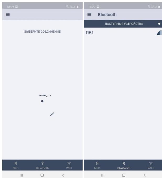
Для подключения к выбранному контроллеру, следует нажать на строке с его именем. APPLICA считывает из него определенные идентификаторы программного обеспечения, после чего проверяет в кэше смартфона наличие ранее загруженного пользовательского интерфейса для данного контроллера.
