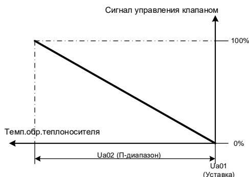
Если установка выключена и от стратегии режима установки получен сигнал активации процедур для холодного времени года, то температура теплоносителя, возвращаемого в сеть, поддерживается на заданном с помощью параметра Ua01 безопасном уровне. Регулирование температуры производится ПИ-регулятором. П-диапазон и время интегрирования регулятора заданы параметрами Ua02 и Ua03 соответственно.
