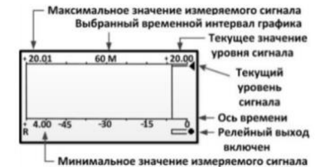
Рисунок G. Экран «graph» с графиком изменения сигнала
