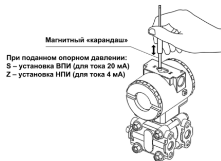
Рисунок В. Расположение местных регуляторов настройки. Отверстие установки нуля обозначено Z (Zero), диапазона – S (Span)
