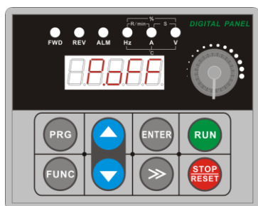
Рис. 3-1 Состояние инициализации. На дисплее сообщение «P.OFF»
