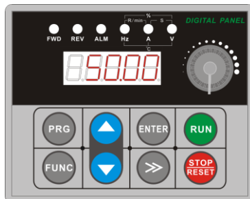
Рис. 3-2 Отображение действующих значений в режиме останова На дисплее «Задающая частота» «50.00»
